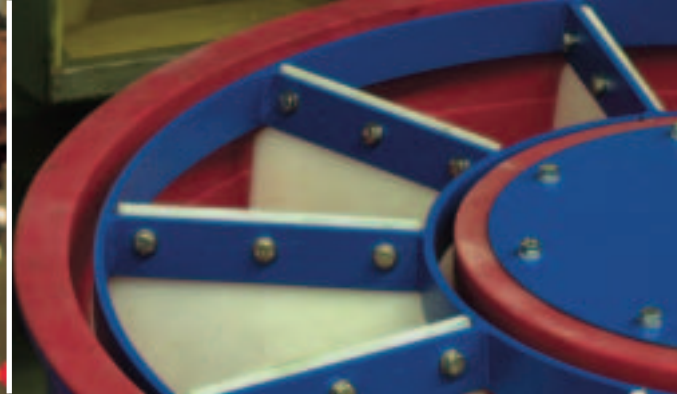
Rueda compartimentada (opcional) para el procesamiento de piezas grandes y delicadas.
