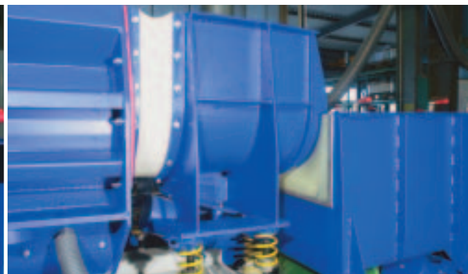
Canal de descarga independiente con un sistema de vibración incorporado
